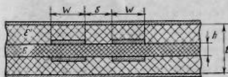
Рис. 6.12. Поперечное сечение связанной трехслойной микрополосковой линии. \epsilon — диэлектрическая постоянная подложки; \epsilon' — диэлектрическая постоянная среды, заполняющей остальное пространство между заземленными пластинами
